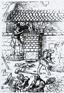
Fabrication de fer dans un bas fourneau au Moyen Âge.
